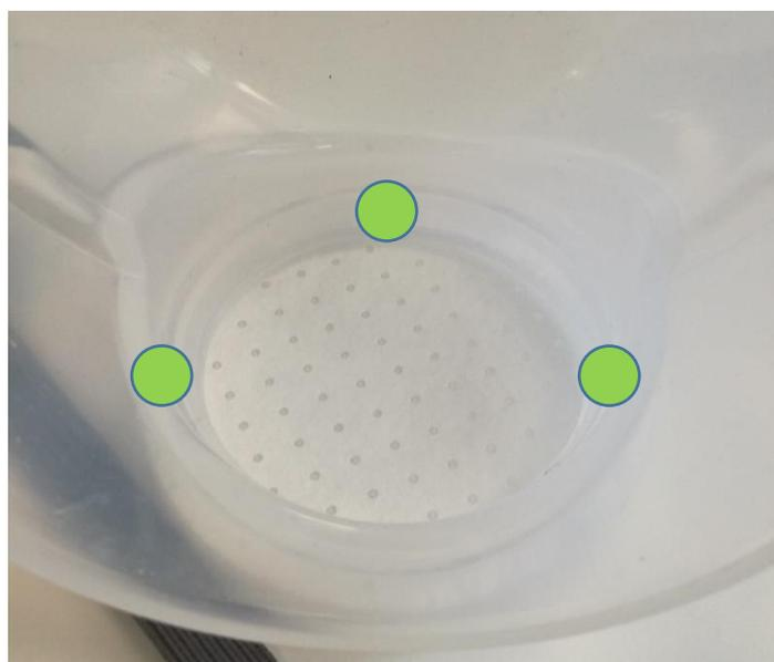
Figura 7 . Corpo della mascherina appoggiato sul filtro, evidenziati in verde i punti in cui applicare pressione
