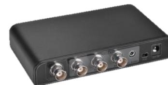
Nelle applicazioni dove necessita il Video di qualità ma in standard PAL si deve inserire lo Scaler HDMI>SDIPRO che dispone di ingresso HDSDI e provvede oltre a duplicare le uscite in HDSDI a convertire il segnale in Videocomposito PAL
