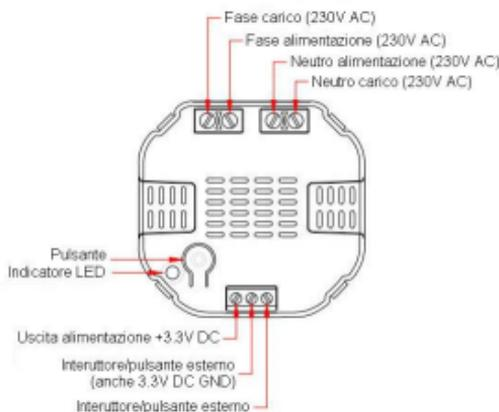
**Nota:** per evitare cortocircuiti che potrebbero danneggiare il dispositivo e per garantire la sicurezza durante la fase di installazione si consiglia di scollegare la corrente elettrica generale.
