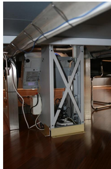
Meccanismo collocato sotto il tavolo e fissato a pavimento
