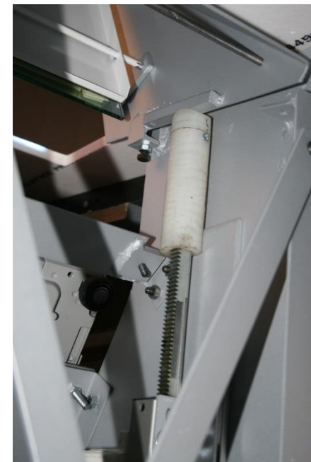
Dettaglio cremagliera espulsione specchio
